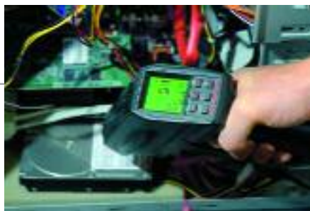
Замерения температуры производились с помощью пирометра в трех точках корпуса
