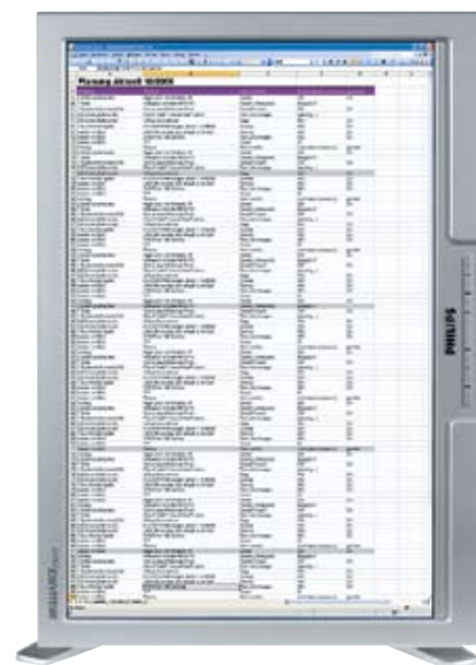
ФУНКЦИЯ «PIVOT» Если повернуть Philips 230WP7 на 90°, на экране поместится 101 строка таблицы Excel
