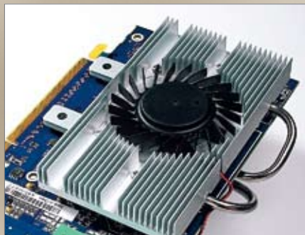
В КРАЙНЕМ СЛУЧАЕ Вентилятор, который находится на обратной стороне модели Sapphire X1600 XT Ultimate, начинает работать только при перегреве графического процессора
