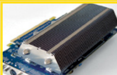
SAPPHIRE RADEON X1650PRO ULTIMATE: Даже мощная, но пассивная система охлаждения — препятствие для разгона
