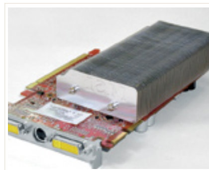
MSI RX1650XT-T2D256EZ Система охлаждения лидера теста весьма массивна, хотя и проще, чем у ASUS
