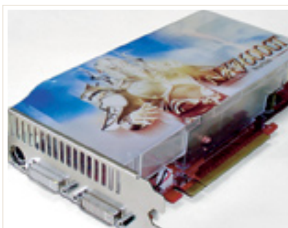
MSI NX7600GT отличается более эффективным турбинным типом охлаждения
