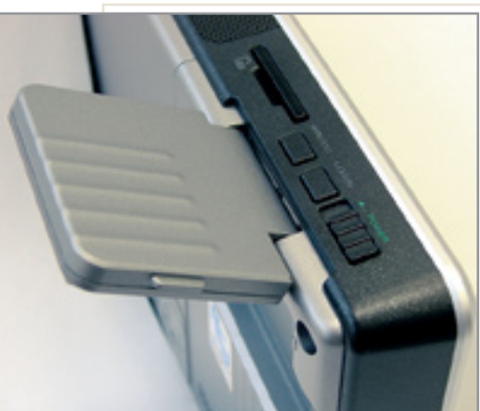
ОТКИДНАЯ АНТЕННА GPS-ПРИЕМНИКА регулируется в одной плоскости
