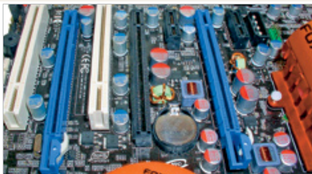
ВПЕРВЫЕ ДЛЯ CORE 2 появилась возможность использовать две видеокарты в SLI-режиме на чипе nForce 680i SLI. Аналогичное решение от Intel пока только ожидается
