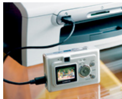
МФУ BROTHER оснащены кард-ридером и портом для подключения камер PictBridge
