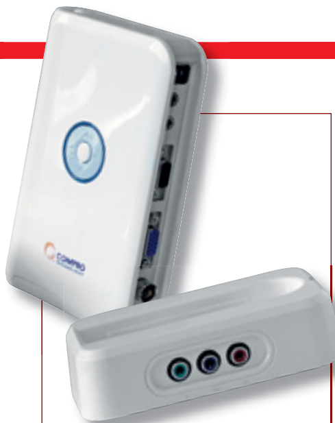
COMPRO VIDEOMATE V550 — типичный автономный ТВ-тюнер. С его помощью можно смотреть телепрограммы даже на мониторе, не подключенном к ПК. Устройство имеет привлекательный дизайн и широкие возможности подключения, но стоит довольно дорого
