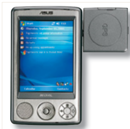
ASUS A636N показывает высокую чувствительность GPS-навигатора при откинутой внешней антенне
