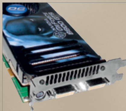
ВСЕ ПЛАТЫ СЕРИИ 8800 занимают два слота, в том числе и в версии 320 Мбайт
