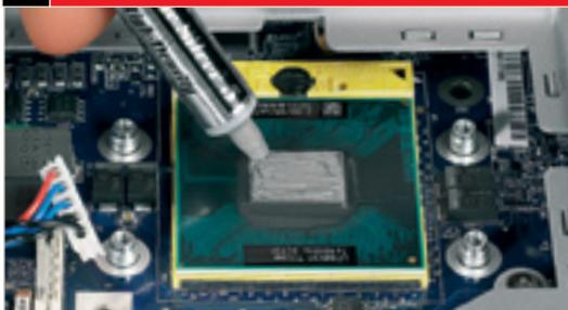
Нанесите на поверхность Core 2 Duo тонкий слой термопасты, чтобы улучшить теплоотвод. Теперь установите все детали на место в обратном порядке (шаги 5, 4 и 2). Готово!
