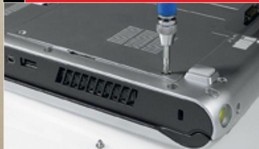
Процессор и система охлаждения находятся под нижней панелью, расположенной вблизи вентиляционного канала (с красной маркировкой). Открутите оба шурупа крестообразной отверткой и снимите панель.
