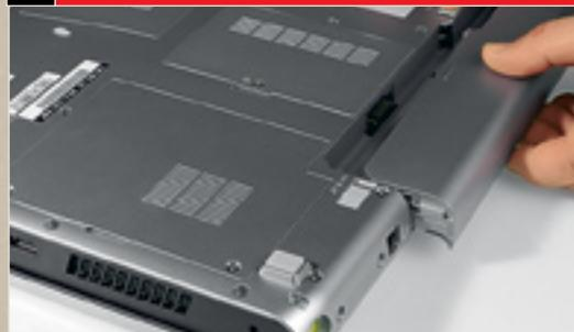
Прежде чем вскрывать ноутбук, его необходимо обесточить. Для этого отключите блок питания и отсоедините аккумулятор: снимите с него блокировку и потяните на себя.
