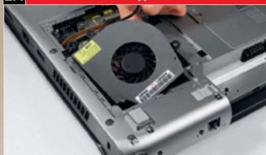
Шурупы, крепящие вентилятор, удалены, а кабель энергоснабжения отключен от материнской платы. Теперь снимаем вентилятор.
