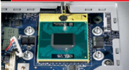
Установите новый процессор Core 2 Duo (как показано на фотографии) в цоколь. Установить его неправильно невозможно, так как существует только один способ вставить процессор в гнездо. После этого закрепите фиксатор.
