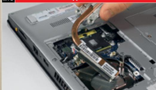
После того как четыре шурупа, крепящие тепловую трубку, отвинчены, а штекер дисплея отсоединен (см. шаг 3), можно снять систему охлаждения. Процессор свободен.
