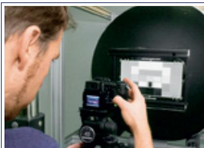
**НЕПОДВИЖЕН КАК СКАЛА** Чтобы измерения были достаточно точными, смещение аппарата между двумя соседними кадрами не должно превышать 1/4 пикселя
