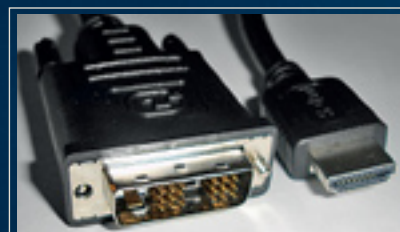
ИНТЕРФЕЙС HDMI , в отличие от своего предшественника DVI, передает и изображение, и звук
