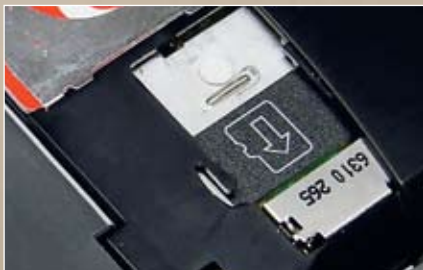
MOTORAZR V3XX Слот для карт памяти microSD располагается под крышкой аккумулятора
