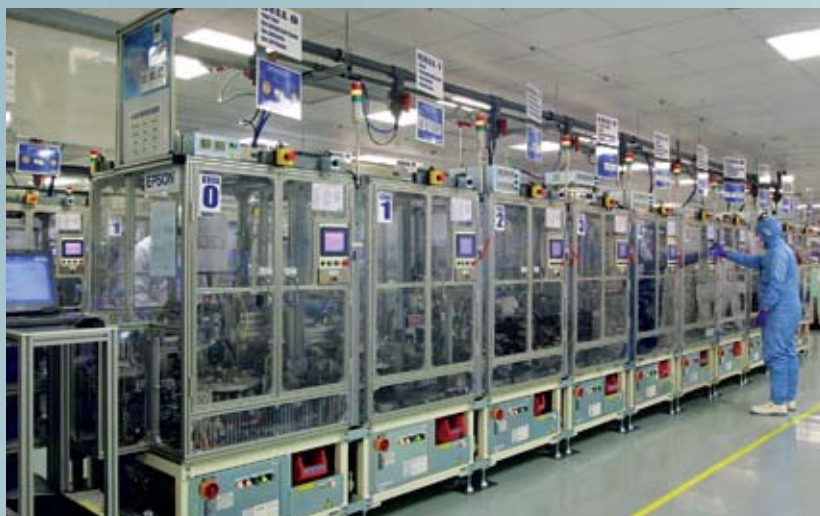
ТОЛЬКО РОБОТЫ Производство картриджей для струйников требует особой чистоты в помещении. Поэтому оно полностью автоматизировано, чтобы зайти в цех, люди надевают специальные комбинезоны
