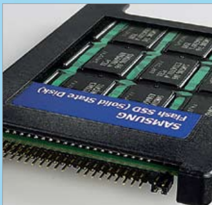
SOLID STATE DISK Замена обычного жесткого диска на флеш-накопитель позволяет сэкономить энергию, но пока обходится дорого
