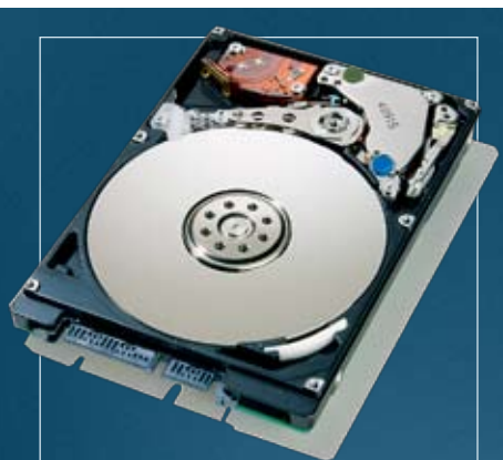
HITACHI DESKSTAR — первый в мире 3,5-дюймовый жесткий диск емкостью 1 Тбайт: пять пластин по 200 Гбайт
