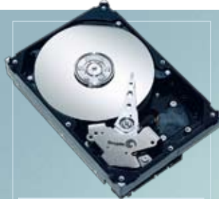
SEAGATE 7200.10 — первый 3,5-дюймовый HDD с технологией перпендикулярной записи
