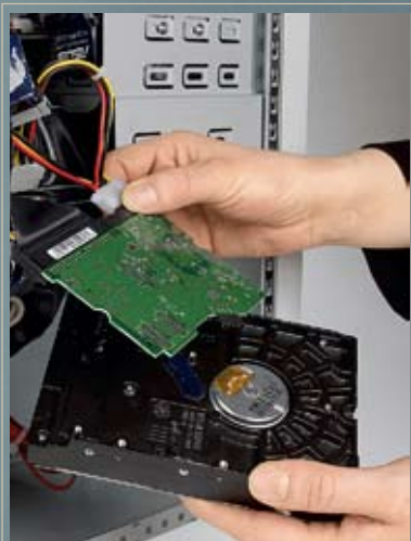
5 ЗАМЕНА ПЛАТЫ Для того чтобы обойти программу запуска, плату управления можно заменить в процессе работы
