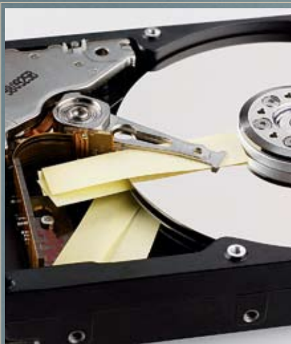
6 ЗАМЕНА СЧИТЫВАЮЩИХ ГОЛОВОК При замене головок проложите между ними и магнитными дисками полоски бумаги, чтобы избежать соприкосновения
