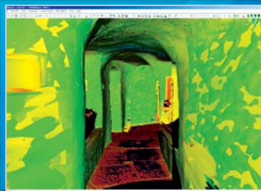
ЛАВРСКИЕ ПЕЩЕРЫ: Точечная модель участка съемки (слева), план подземелий в масштабе 1:500, с отметками пола и свода (в центре), триангуляционная поверхность (TIN - модель, справа)
