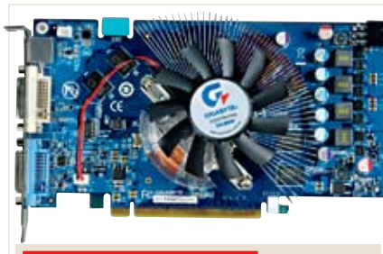
GIGABYTE GV-NX88T512HP фирменный кулер Zalman делает карту «двухэтажной»
