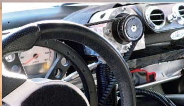
СОБСТВЕННАЯ ПОСТРОЙКА: курьезом на краю трассы стал Lotus с рулевым управлением из клинового ремня
