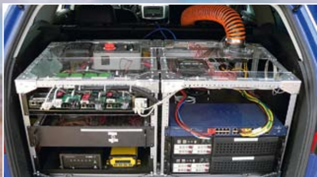
Вся система управления роботизированного Juniper помещается в багажнике — два компьютера, коммутатор и управляющая сенсорами электроника
