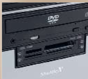
5 ОХОТНИК ЗА БУКВАМИ Встроенный карт-ридер зачастую резервирует важные буквенные обозначения дисков: C, D, E и F
