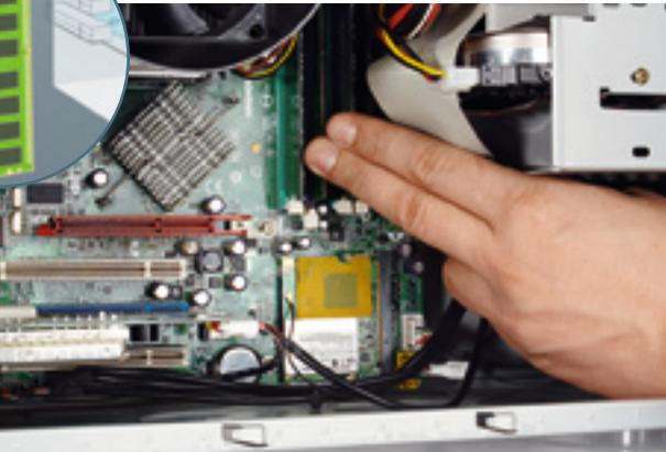
ПК, выпущенных до 2005 года) или новый PCI Express x16 (используется примерно с конца 2005 года). Точную информацию можно получить в драйвере видеоплаты или при помощи утилиты GPU-Z.
