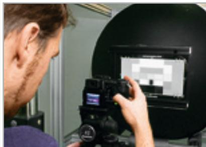
**НЕПОДВИЖЕН КАК СКАЛА** Чтобы измерения были максимально точными, смещение аппарата между двумя соседними кадрами не должно превышать 1/4 пикселя
