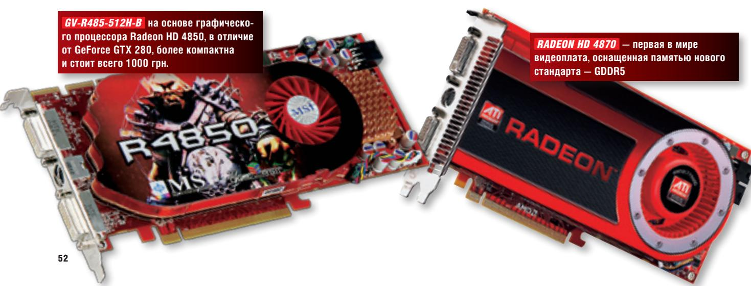
расчетов общего назначения. Так, производительность Radeon HD 4850 — около 1 Тфлопс, а Radeon HD 4870 — 1,2 Тфлопс. При выполнении операций с двойной точностью производительность снижается до 240 Гфлопс.
