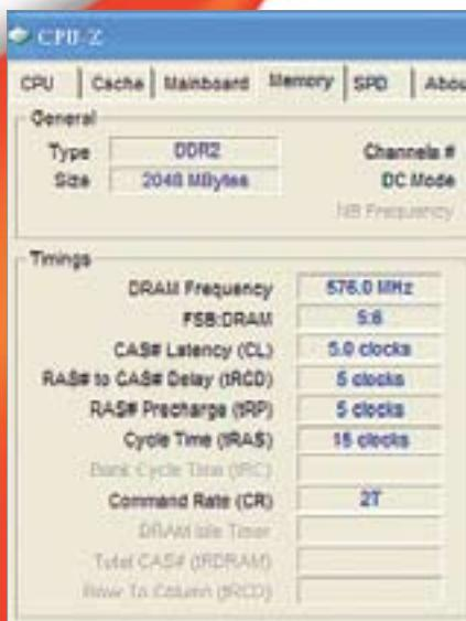
**УТИЛИТА CPU-Z** поможет узнать текущую частоту, делитель и тайминги оперативной памяти
