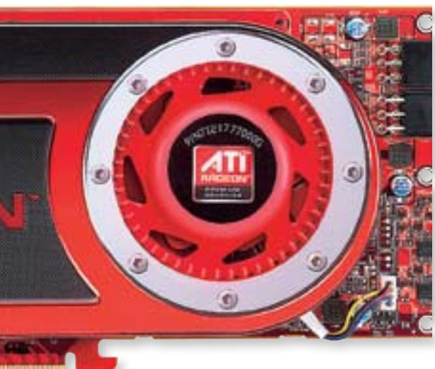
**AMD RADEON HD 4870** содержит 800 потоковых процессоров — в 2,5 раза больше, чем видеоплаты семейства Radeon HD 3800
