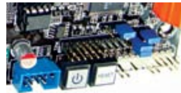
ASUS P6T DELUXE оснащена кнопками вкл./выкл. питания и Reset, что облегчает использование без корпуса
