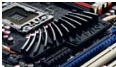
WIND-FLOW PIPE уникальная конструкция термотрубок для эффективного отведения тепла
