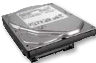
**Hitachi P7K500 (HDP725050GLA360)** Тихий диск с интерфейсом SATA и емкостью 500 Гбайт. Недорогая модель с хорошей скоростью передачи данных (78,5 Мбайт/с), но большим временем доступа (14,4 мс).
