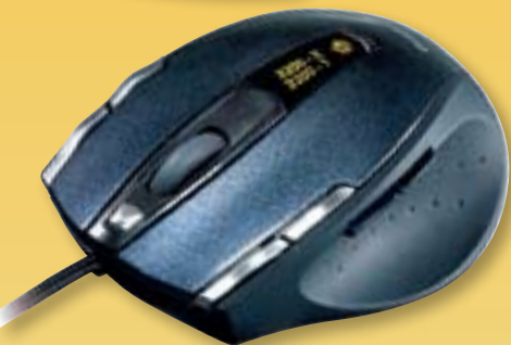
GENIUS ERGO 555 OLED-дисплей мышки показывает текущее разрешение и активный игровой профиль
