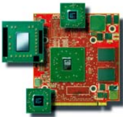
ПЛАТФОРМА PUMA состоит из трех компонентов — процессора семейства Griffin, набора микросхем M780G и дискретного видеоадаптера (опционально)
