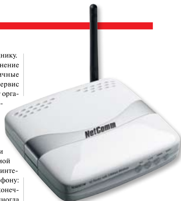
БЕСПРОВОДНОЙ МАРШРУТИЗАТОР NetComm N3G001W уже оснащен встроенным 3G-модемом. Для выхода в Интернет необходимо лишь вставить в него SIM-карту
