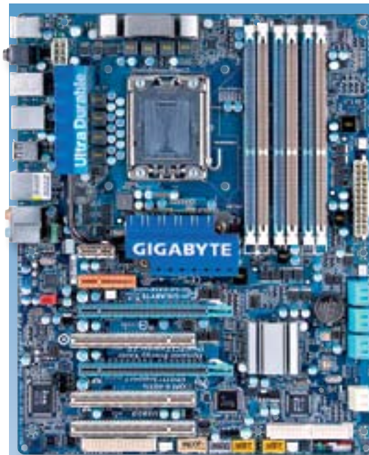
GA-EX58-UD4 выполнена по технологии Ultra Durable 3 — ее проводящий и заземляющий слои в два раза толще, чем у обычных плат
