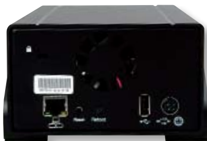
ВЕНТИЛЯТОР на шариковых подшипниках отличается низким уровнем шума
