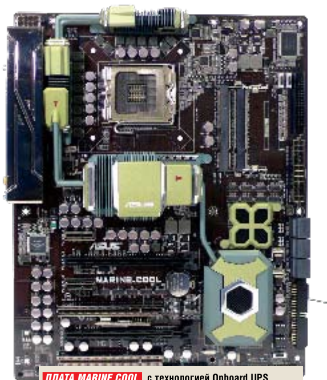
ПЛАТА MARINE COOL с технологией Onboard UPS оснащена встроенной полимерной батареей, которая играет роль резервного источника питания
