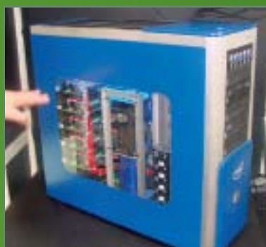
5 МИКРО-ITX плат с процессорами Core E8400 смонтированы в корпусе CoolerMaster. Суммарная частота — 30 ГГц
