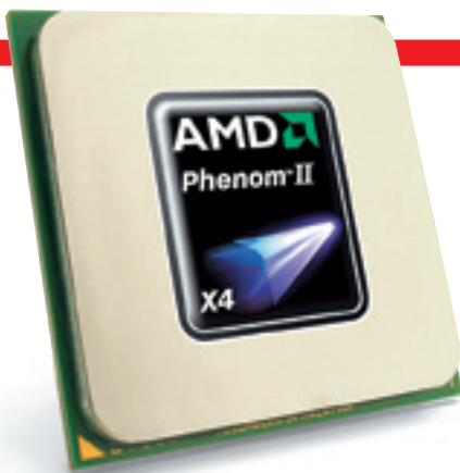
PHENOM II С РАЗЪЕМОМ SOCKET AM3 — первые процессоры AMD для настольных систем с поддержкой памяти стандарта DDR3
