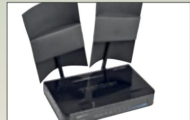
Для устройства с двумя антennами входами можно смастерить двойную параболическую антенну из картона, обклеенного фольгой. Она будет излучать сфокусированный сигнал в одном направлении. Подробную инструкцию по изготовлению вы найдете на сайте [www.freeantennas.com](http://www.freeantennas.com).
