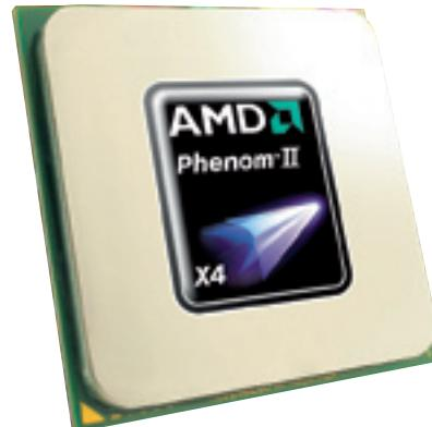
**AMD PHENOM II X4 955** Теперь в состав игрового компьютера входит новый топовый процессор AMD, работающий на частоте 3,2 ГГц и обладающий свободным множителем
