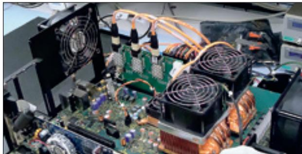
В экспериментальной установке вместо модуля памяти имеется оптическая система передачи информации, с помощью которой исследуются возможные архитектурные особенности компьютеров ближайшего будущего
