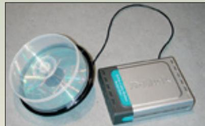
Используя всенаправленную антенну, созданную из обычного CD, упаковки для оптических дисков и проволоки, можно получить выигрыш в мощности порядка 10 дБ для старых маршрутизаторов. Увы, современные модели стандарта 802.11n не будут работать с подобной антенной.
