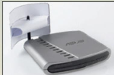
Съемная параболическая антенна фокусирует сигнал лучше, чем стандартная, от производителя. Это обеспечивает повышенную скорость передачи данных при прохождении радиоволн сквозь препятствия. Порядок ее изготовления описан в CHIP №7 2009 в статье «Как повысить скорость WLAN».
