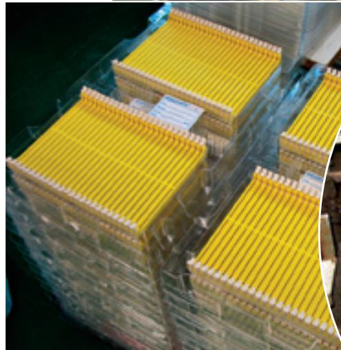
**DIMM-РАЗЪЕМЫ** обычно устанавливаются на плату в первую очередь
