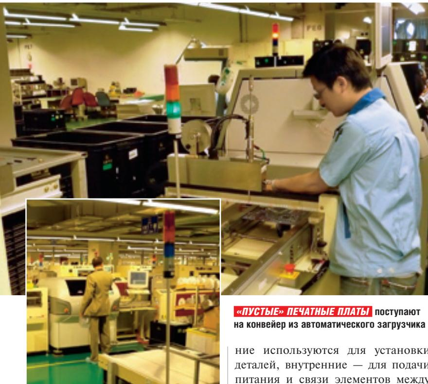
«ПУСТЫЕ» ПЕЧАТНЫЕ ПЛАТЫ поступают на конвейер из автоматического загрузчика
