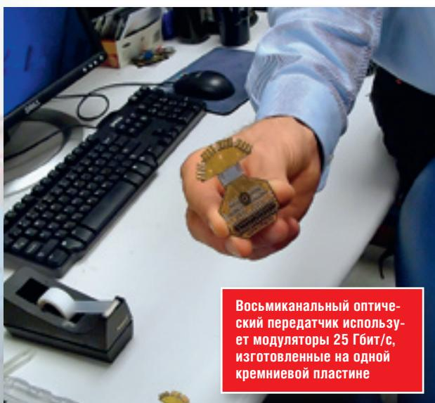
Восьмиканальный оптический передатчик использует модуляторы 25 Гбит/с, изготовленные на одной кремниевой пластине
