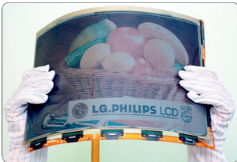
ГИБКИЙ ЦВЕТНОЙ ДИСПЛЕЙ на основе технологии электронной бумаги от компании LG.Philips обладает диагональю 14,1 дюйма и отображает 4096 цветов
