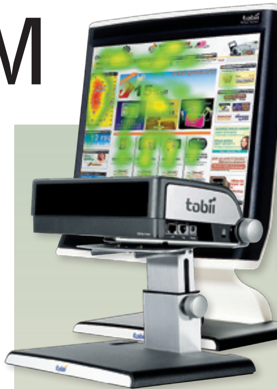
EYE TRACKER прибор для отслеживания движений глаз от компании Tobii
