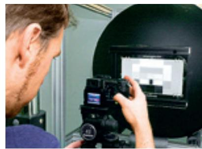
**НЕПОДВИЖЕН, КАК СКАЛА** Чтобы измерения были максимально точными, смещение аппарата между двумя соседними кадрами не должно превышать 1/4 пикселя
