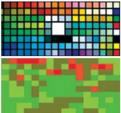
**ПРОВЕРКА ЦВЕТОПЕРЕДАЧИ** Восемь различных тестовых изображений автоматически оцениваются. При этом генерируется карта цветопередачи камеры. Светло-зеленый цвет означает отличный уровень, темно-зеленый — приемлемый, а красный — значительные отклонения от оригинала
