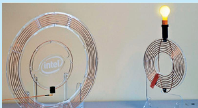
**ЭЛЕКТРОПИТАНИЕ ПО ВОЗДУХУ** В ходе эксперимента, продемонстрированного компанией Intel, посредством технологии WREL удалось без проводов запитать лампочку мощностью 60 Вт на расстоянии менее метра от передатчика
