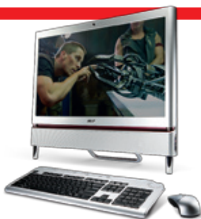
В ACER ASPIRE Z5610 используется достаточно редкий в настоящее время оптический сенсорный экран, поддерживающий технологию Multitouch
