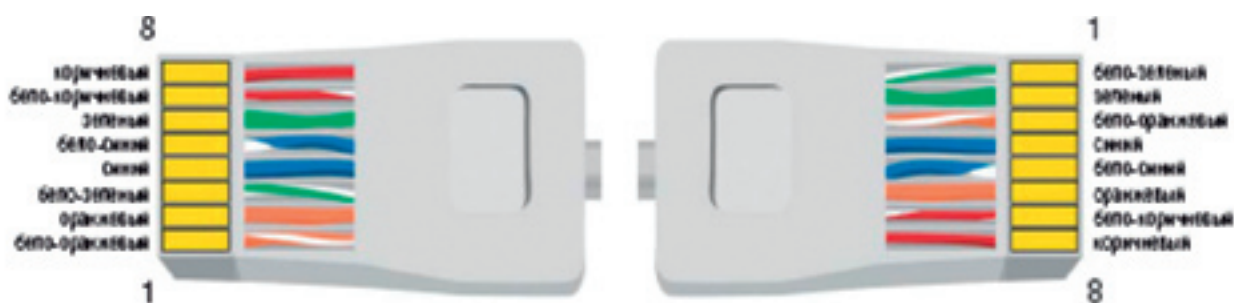
«ОБРАТНАЯ ОБЖИМКА» Такой коммутационный кабель позволяет соединить два компьютера напрямую
