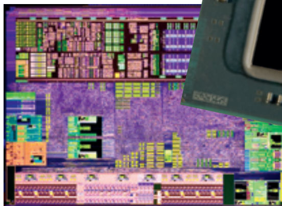
ПРОЦЕССОР INTEL ATOM N450 оснащается интегрированным видеоядром и контроллером памяти
