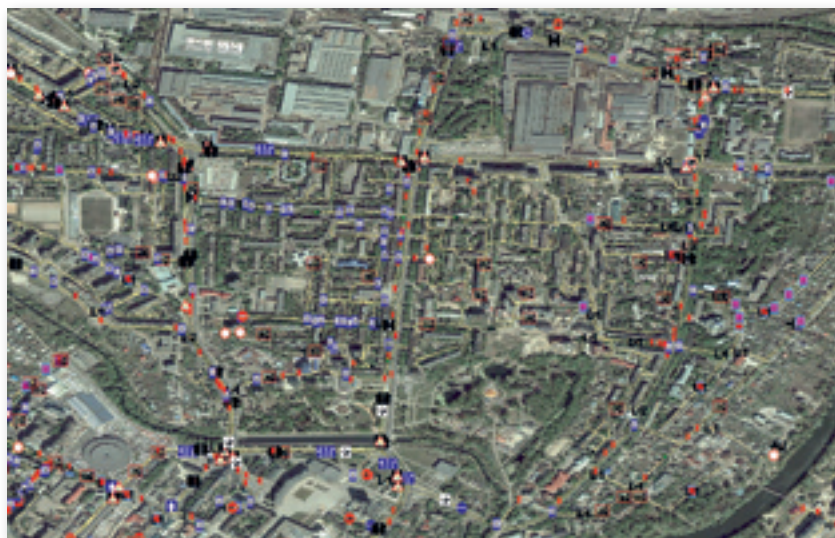
ЗДЕСЬ ПРОЕХАЛ СБОРЩИК ИНФОРМАЦИИ и зафиксировал все данные, какие смог: возможность проезда, дорожные знаки, разметку и многочисленные точки интереса
