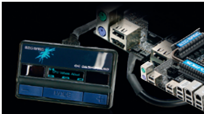
MSI BIG BANG FUSION оснащается специальной выносной панелью для упрощения процедуры разгона
