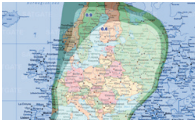
Зона действия спутника Astra 2C охватывает всю территорию Украины. Цифры на карте указывают на рекомендуемый диаметр спутниковой антенны
