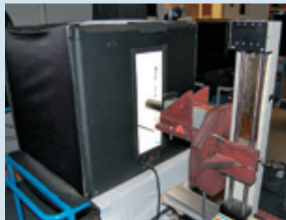
Тестовый стенд позволяет измерить параметры всех телефонов с одинаковым расстояния и при равном уровне освещения
