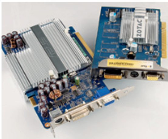
Пассивное охлаждение Безвентиляторные видеокарты абсолютно бесшумны, но, несмотря на это, позволяют играть в игры
