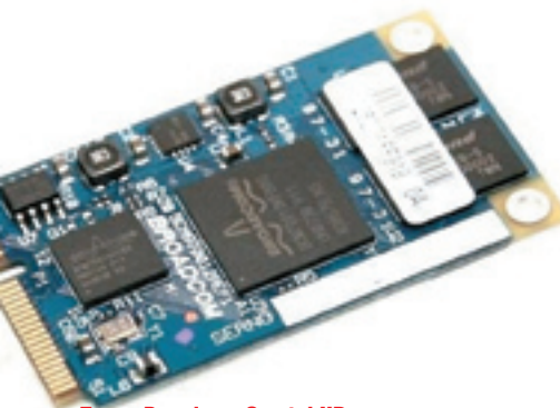
Плата Broadcom Crystal HD является решением проблемы для воспроизведения видео Full HD на маломощном нетбуке
