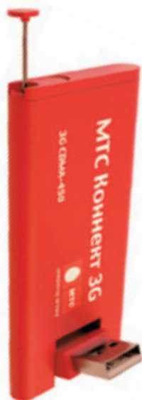
Модем «МТС Коннект 3G» снабжен внешней антенной, что существенно повышает шансы соединения с Интернетом в зонах неуверенного приема или когда сигнал слишком слабый
