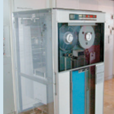
IBM 729V — один из первых накопителей данных на магнитной ленте
