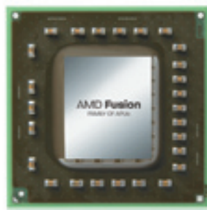
Мобильные процессоры AMD обладают миниатюрными размерами и производятся по 32-нанометровому техпроцессу
