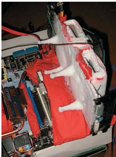
Разгон GPU также можно осуществлять с использованием жидкого азота
