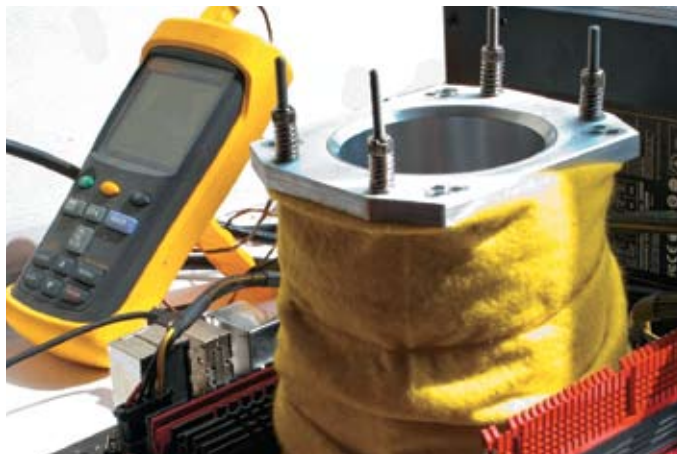
При экстремальном оверклокинге важнейшие параметры напряжений выводятся на внешние вольтметры — штатные средства недостаточно точны
