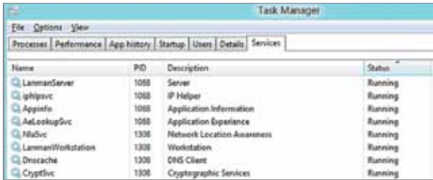
При старте Windows 8 запускает минимальное количество служб, что обеспечивает малое время готовности системы. Остальные службы находятся в спящем режиме
