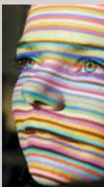
Лазерный сканер или инфракрасный проектор (как в Xbox Kinect) обмануть труднее всего, так как качество распознавания не зависит от освещенности и ракурса. Зато подобные системы очень дороги и к тому же подвержены влиянию посторонних предметов, таких как шляпа.
