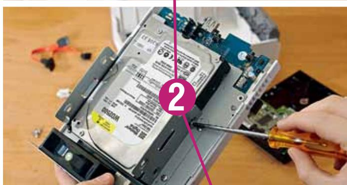
**3 ОТСОЕДИНАЕМ ПЛАТУ УСТРОЙСТВА** Теперь открутите винты, которыми крепятся к корпусу салазки жесткого диска и платы. Осторожно извлеките последнюю из зажимов и отложите в сторону, лучше всего на чистую и мягкую поверхность, например кусок пористой резины. На следующем этапе мы займемся корпусом NAS.
