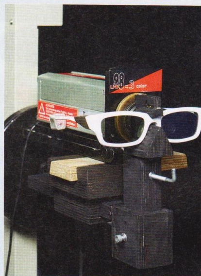
Для измерения влияния эффекта crosstalk мы использовали новый метод тестирования
