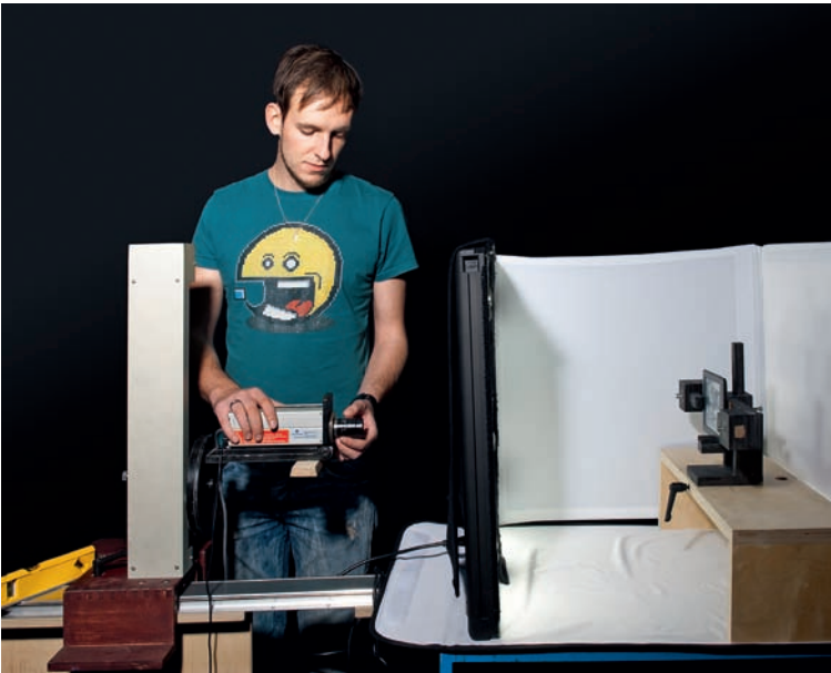
Равномерность подсветки мы проверяли с помощью специальной камеры, измеряющей яркость. При этом она использует данные о 1,3 млн точек
