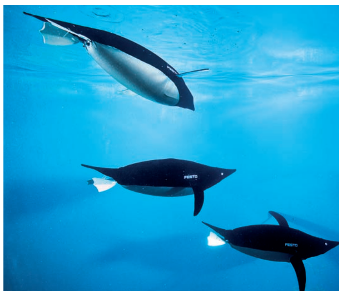
Робот Aquapenguin, созданный в лабораториях Festo, управляется 3D-сонаром при движении в наполненном водой бассейне. Его подвижный (сгибающийся) корпус мог бы представлять интерес при создании промышленных роботов
