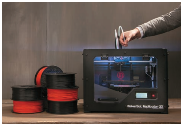
FDM-технология позволяет оперировать 3D-принтером без каких-либо неудобств для пользователя. Пластиковая нить может быть различных расцветок, а ее толщина составляет от 0,15 до 0,5 мм
