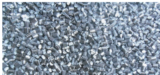
ABS-пластик прочнее, поэтому для работы с ним нужна более высокая температура нагрева, чем в случае с PLA
