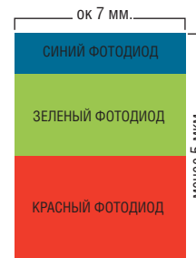
Принцип цветоделения у матриц Foveon основан на разной глубине поглощения света с разной длиной волны в атоме кремния. Каждый пиксель такой матрицы полноцветный. В условиях низкой освещенности сенсоры Foveon проявляют себя не очень хорошо
