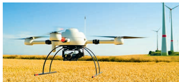
Дроны с автономным управлением, такие как md4-1000 от Microdrones, проводят проверку промышленных установок (например, ветровых колес) на наличие повреждений
