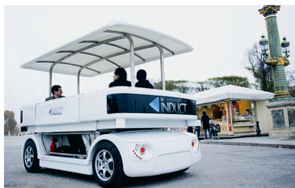
Роботизированные мини-автобусы Induct Navia уже курсируют по улицам Сингапура со скоростью 20 км/ч и перевозят до восьми человек одновременно
