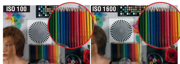
Цифровые шумы делают непригодными для использования высокие значения ISO на некоторых моделях камер
