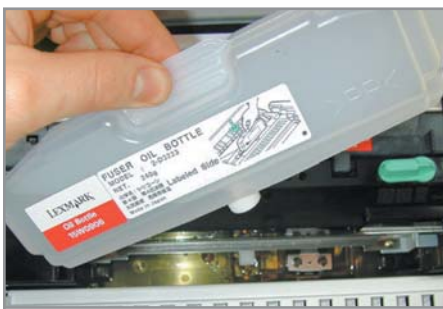
Масляный картридж: в некоторых цветных лазерных принтерах масло нужно для того, чтобы тонер прилипал к бумаге, а не к фиксирующему валу
