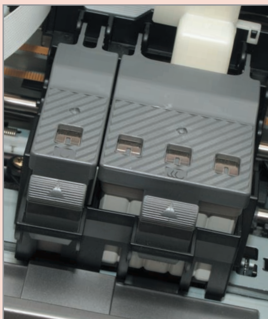
▲ Под обоими клапанами находятся картриджи с чернилами: один с черными и один с цветными
