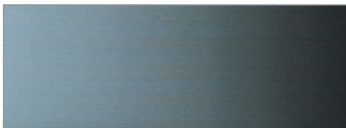
14. Разноцветная серость: при быстрой печати в обоих направлениях может случиться, что серая заливка будет расцвечена цветными полосками
