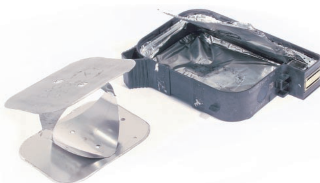
Внутри картриджей HP находится специальная пружинка, которая разжимается при разгерметизации корпуса
