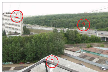
Нетривиальная задача: чтобы соединить соседние микрорайоны (дома 1 и 3), кабель пришлось вести через мост (2) и затем с разбегу натягивать из-за мешающих посередине деревьев
