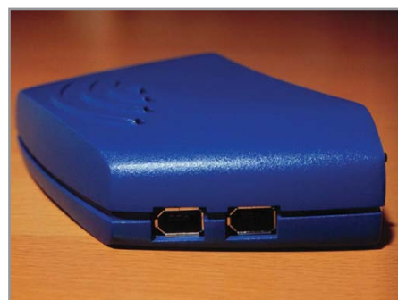
Концентратор FireWire позволяет подключить большее количество устройств
