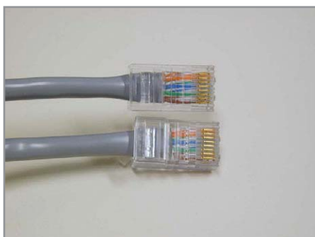
Одинакового обжатия сетевого кабеля разъемами RJ-45 вполне хватит для создания простейшей сети
