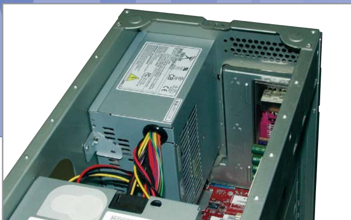
Вертикальное расположение блока питания не всегда бывает полезно из-за возможных проблем с процессорным кулером
