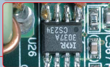
4.2. Микросхема 3037A: благодаря резистору обеспечивается бесперебойная работа системной шины на частоте 400 МГц
