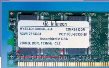
На большинстве модулей памяти указаны рабочие параметры
