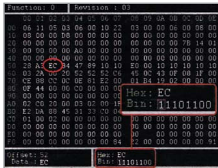
3. Активируем режим ожидания (Idle): для этого в строке 50, колонка 2 первый бит нужно поменять на 1
