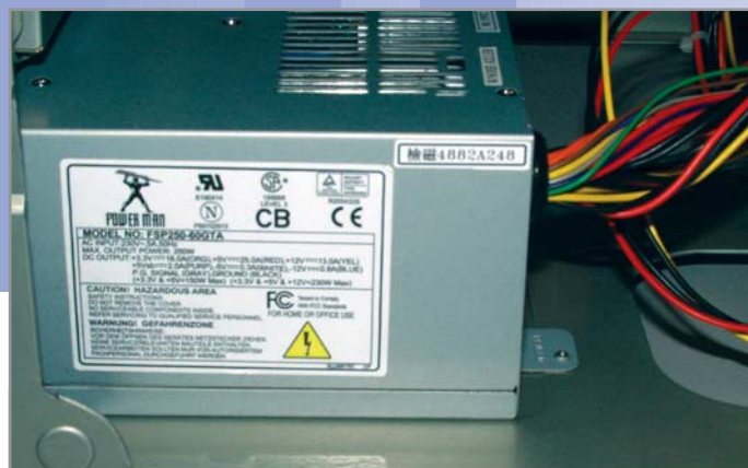
На хорошем блоке питания всегда будет наклейка с подробными данными о производителе и технических параметрах
