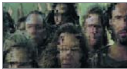
Рис. 2. При обработке кодировщиком bbMPEG динамических сцен появляется большое количество артефактов
