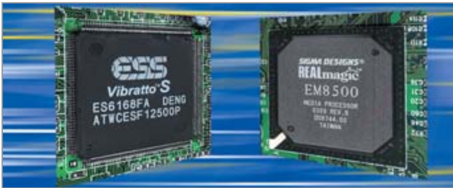
Сегодня существует лишь два чипа-декодера для работы с форматом MPEG-4: Sigma Designs REALmagic EM8500 и ESS Vibratto S
