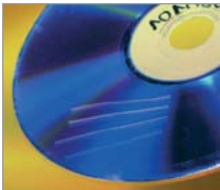
Для оценки стойкости к повреждению царапаем поверхность DVD
