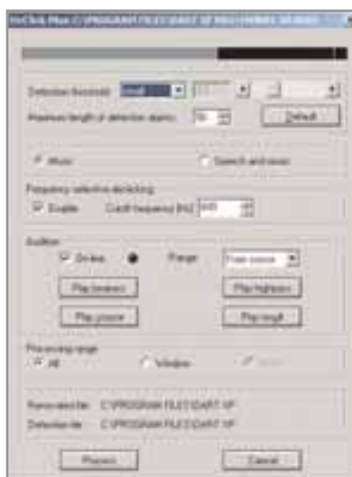
Средство удаления щелчков в DART позволяет сравнить исходную и результирующие записи и подобрать настройки
