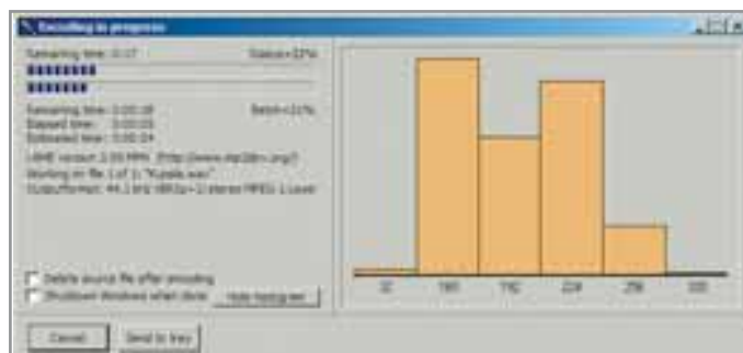
При кодировании с VBR фронтэнд Razorlame выстраивает специальную гистограмму, на которой видно, какой битрейт используется больше, а какой меньше
