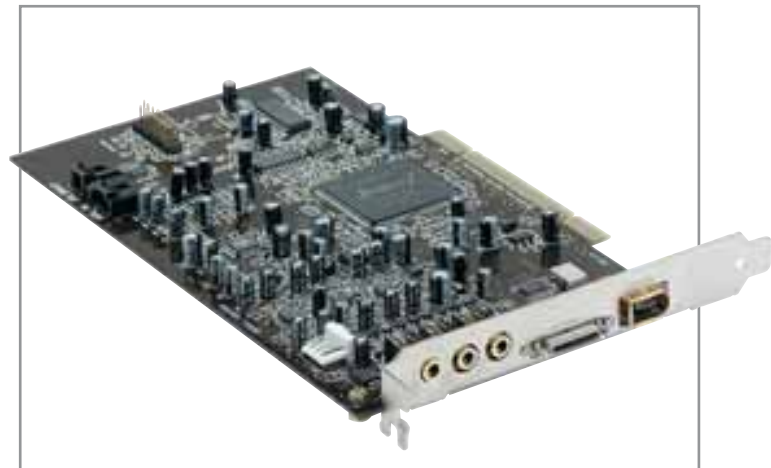
Внутренняя звуковая карта Audigy 2 ZS Platinum Pro перекладывает функции подключения на внешний модуль
