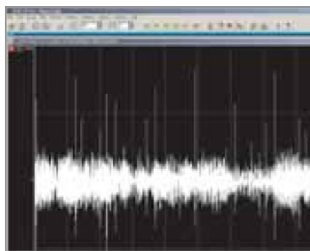
Щелчки, которые программа DART XP должна удалить, на графике отображаются в виде заметных пиков
