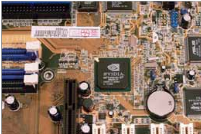
Южный мост чипсета nForce2 содержит в себе мощный APU, выдающий весьма качественный звук
