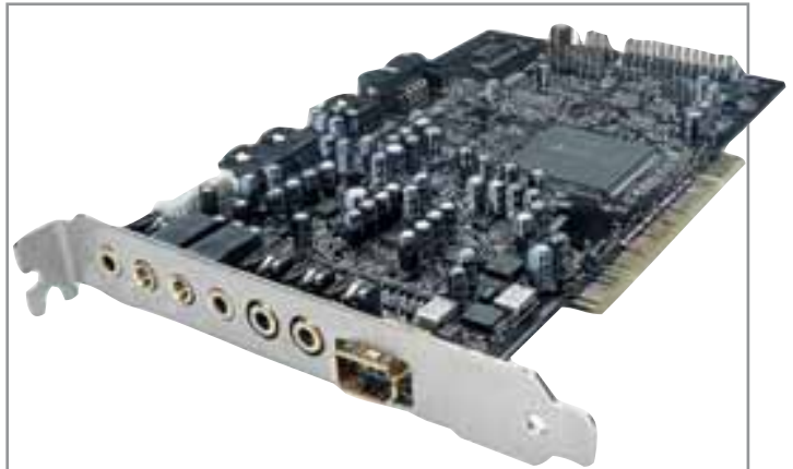
Внутренняя карта Audigy 2 ZS Platinum отличается от версии Pro большим количеством входов-выходов на плате
