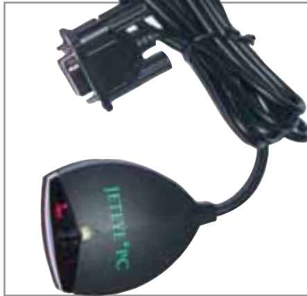
Типичный ИК-приемник старого образца, работающий через COM-порт
