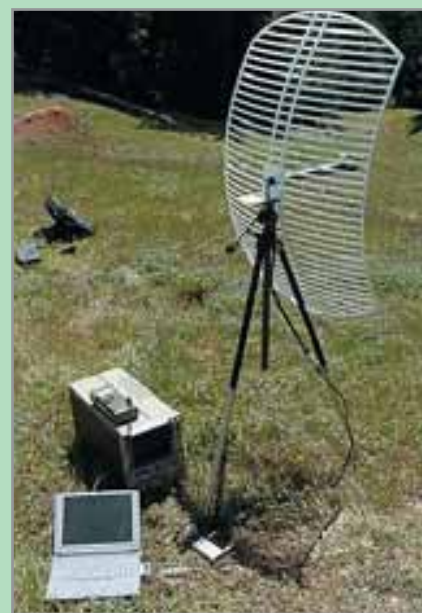
Настройка позиционирования направленной антенны через ноутбук с Wi-Fi-адаптером и спектральный анализатор
