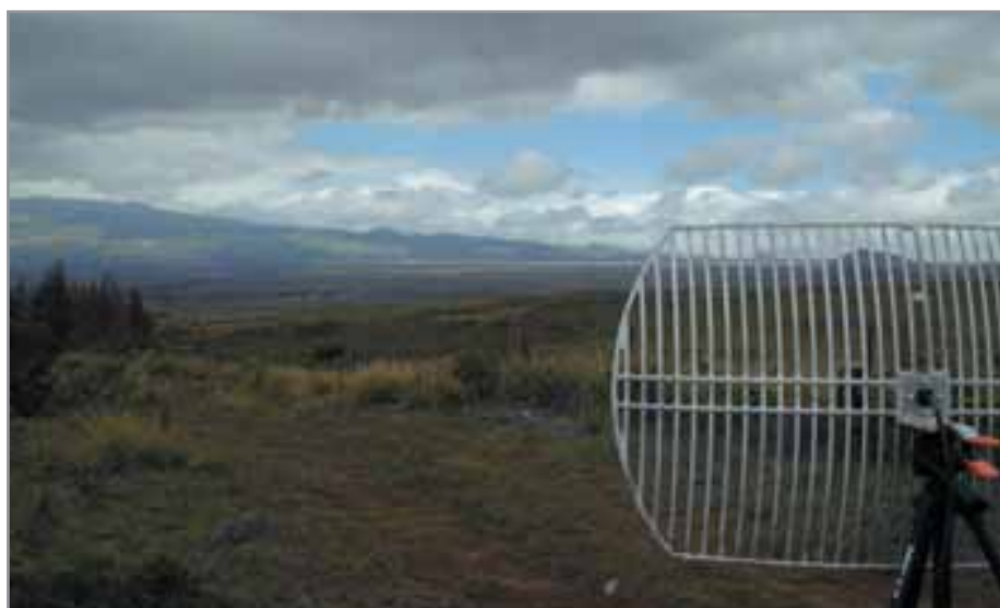
При применении направленных антенн использование Wi-Fi-передатчика возможно на расстояниях, в десятки раз больших, чем указано в спецификациях стандарта
