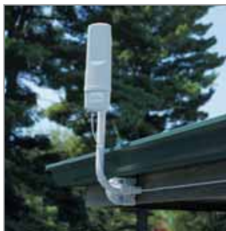
Subscriber Module — модуль, устанавливаемый у конечного пользователя
