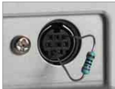
15 Обманули: 820-омное сопротивление создает у сканера иллюзию реального слайд-модуля
