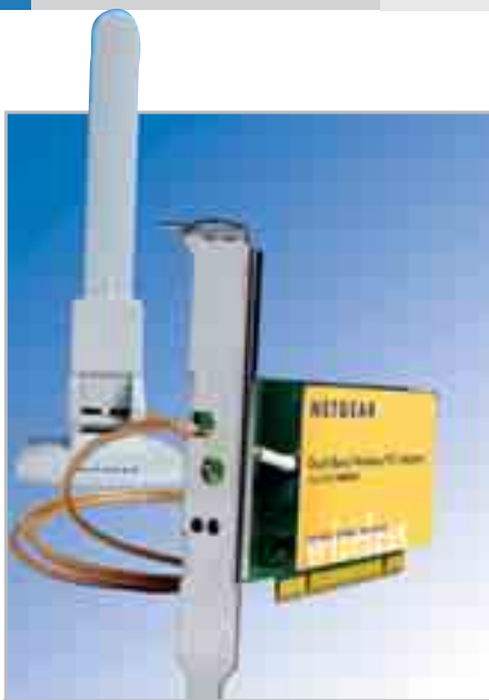
Подключайтесь: внешняя антенна W-LAN увеличивает дальность действия вашей беспроводной точки доступа
