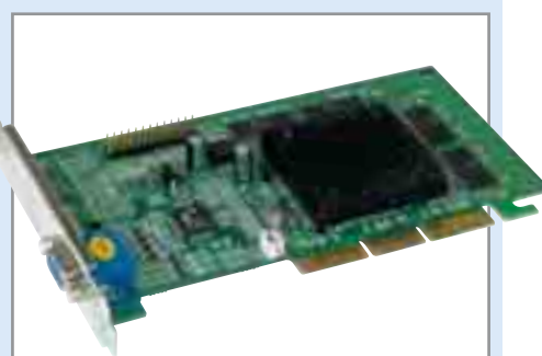
Простое решение: карта S/U/M/A/ Platinum GeForce2 MX 400 PowerUp после установки пассивного кулера
