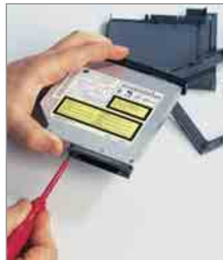
13 Перед монтажом на новый привод необходимо установить переходник
