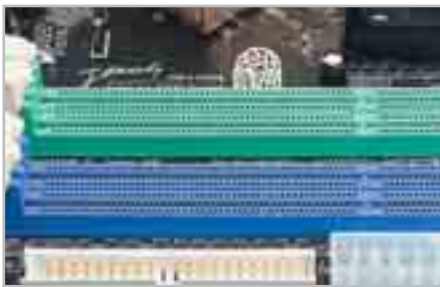
Два слота памяти: чтобы использовать режим Dual Channel, необходимо правильно расположить модули RAM
