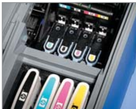
▲ HP Business InkJet 1100D: и чернила, и печатающие головки могут заменяться по отдельности
