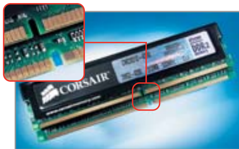
▲ Отличие: модули DDR2 (вверху) и DDR1 (внизу) не похожи только расположением ключа-выреза
