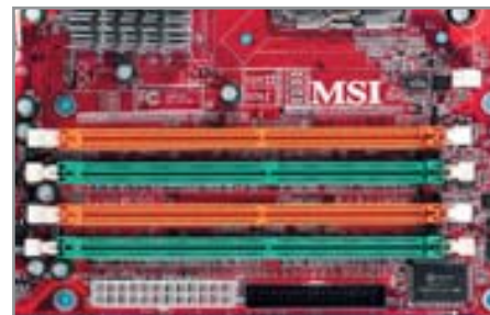
▲ Гибкость: MSI 915G Combo-FR работает и с DDR1 (зеленые слоты), и с DDR2 (оранжевые слоты)
