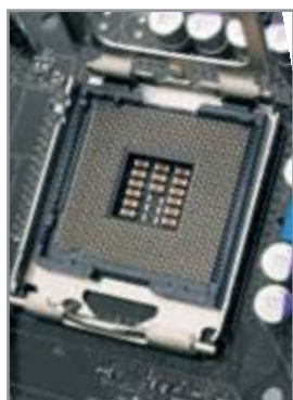
◀ Socket 775: ножки на разъеме обеспечивают контакт с процессором
