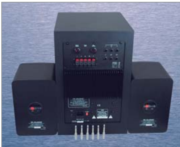
▲ Подача звукового сигнала на StudioPhile LX4 осуществляется при помощи шести Jack-разъемов моно
