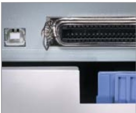
▲ Brother: наряду с портом USB принтер может подключаться и через параллельный порт
