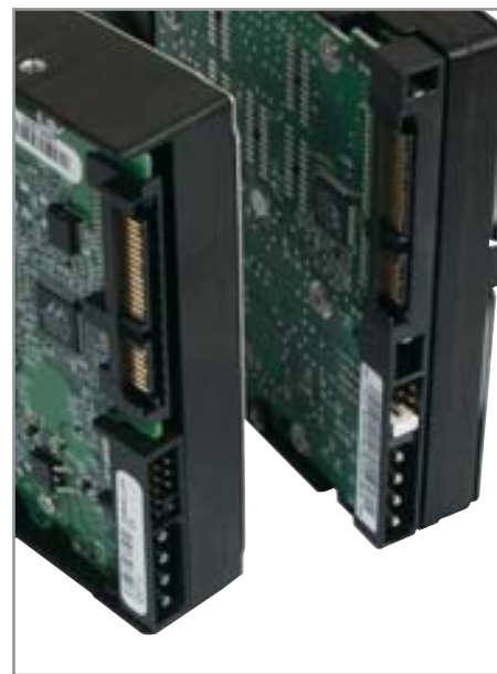
▲ Странное решение компании Maxtor — нет защиты разъемов. Справа показан диск WD1600JD
