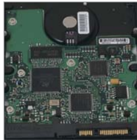
▲ Печатная плата дисков Seagate изобилует различными элементами, которые легко повредить
