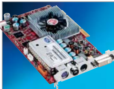
▲ ATI Radeon All in Wonder совмещает в себе функции видеокарты и ТВ-тюнера
