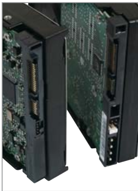
▲ Не все Serial ATA-накопители оснащаются двумя разъемами питания. У Seagate разъем только один
