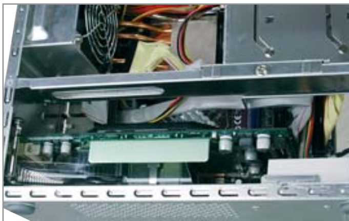
▲ Внутри barebone-систем компании ECS можно разместить даже видеокарты класса GeForce FX5950 Ultra
