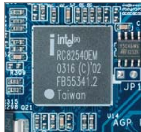
▲ Shuttle AN50R: чип от Intel предназначен для обеспечения работы Gbit-LAN на платах для Athlon 64
