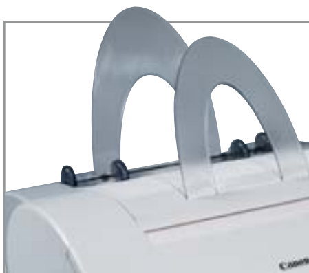
▲ Canon: приемный лоток для бумаги вмещает всего треть от того, что помещается в лоток для подачи
