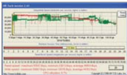
▲ Провалы на графике скорости записи диска Seagate ST312026AS
