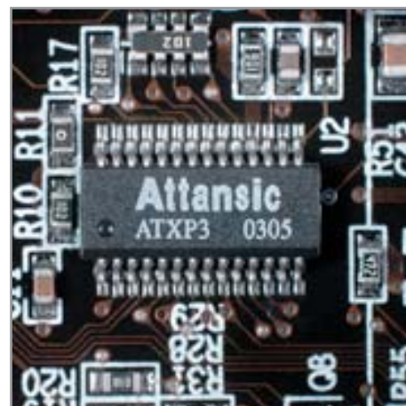
▲ AOpen AK86-L: микрочип Attansic в состоянии управлять работой вентилятора, вплоть до полной остановки
