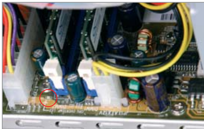
▲ О перегреве процессора сигнализирует светодиодный индикатор на материнской плате Shuttle XPC SN45G
