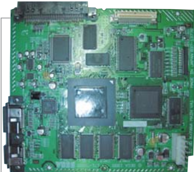
Рис. 3. Материнская плата Dreamcast была сравнительно небольших размеров. Для лучшего теплоотвода на двух основных процессорах стоят резиновые прокладки
