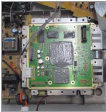
На фотографии отлично видно, что внутри Panasonic Q установлена стандартная плата для GameCube
