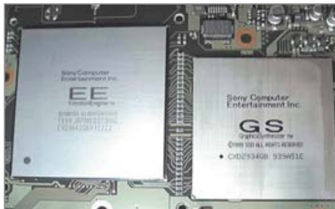
Графический процессор Graphics Synthesizer и вычислительный блок Emotion Engine отдыхают и работают «рука об руку»
