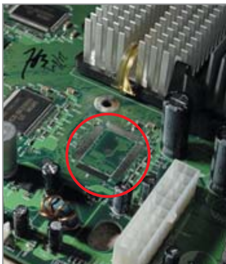
Рис. 14. Контактные площадки для модулей памяти расположены и на тыльной стороне материнской платы
