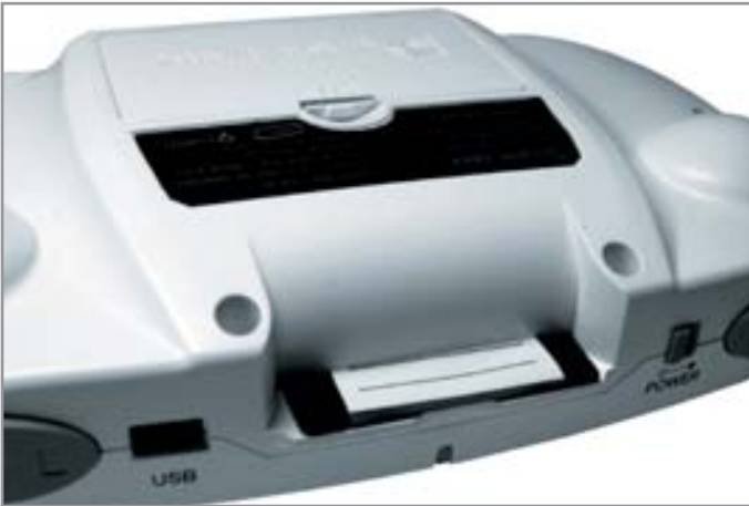
Оборотная сторона GamePark 32: хорошо видны разъемы питания и наушников, порт USB, а также слот для карт Smart Media, отсек для батареек и порт расширения для различных аксессуаров. Эти возможности еще более приближают приставку к КПК
