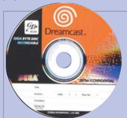
Рис. 5. Пример GD-диска, доступ к которым имели только разработчики игр
