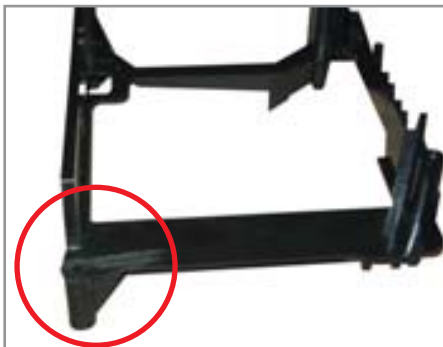
Рис. 16. Подпилить пластиковый бокс для крепления привода можно небольшой ножовкой по металлу или лобзиком
