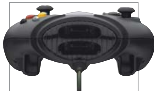
На верхней стороне джойстика расположены два порта для карт памяти
