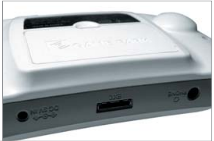
Оборотная сторона GamePark 32: хорошо видны разъемы питания и наушников, порт USB, а также слот для карт Smart Media, отсек для батареек и порт расширения для различных аксессуаров. Эти возможности еще более приближают приставку к КПК
