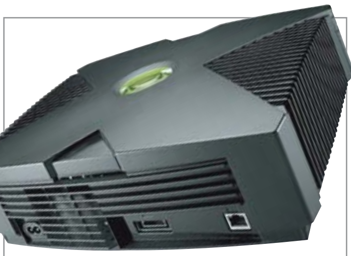
На задней стороне консоли нет ничего лишнего: порт RJ-45 и нестандартный совмещенный разъем аудио/видео
