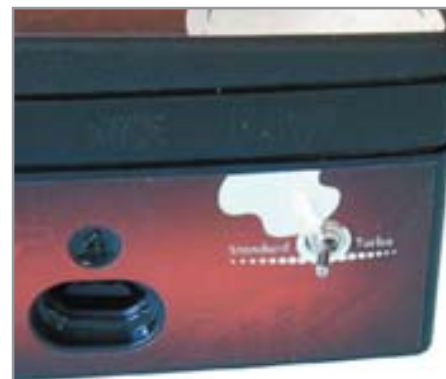
Рис. 15. На лицевой панели модифицированной консоли несложно заметить переключатель, отвечающий за частоту ЦП
