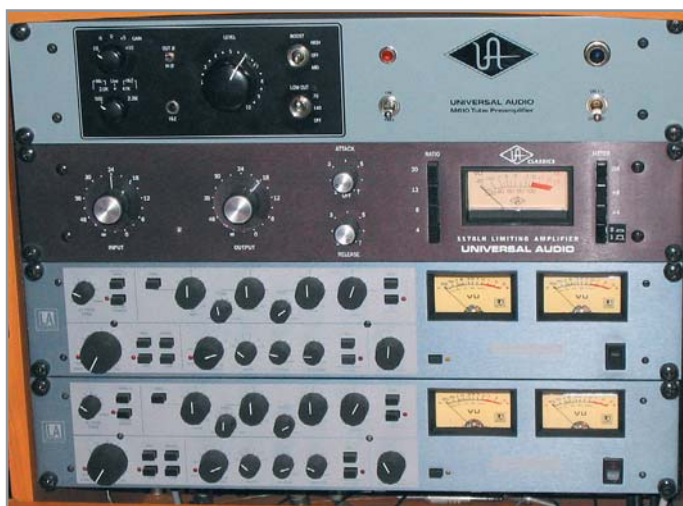
Сверху вниз: предусилитель Universal Audio M610, компрессор Universal Audio 1176, два компрессора LA Audio
