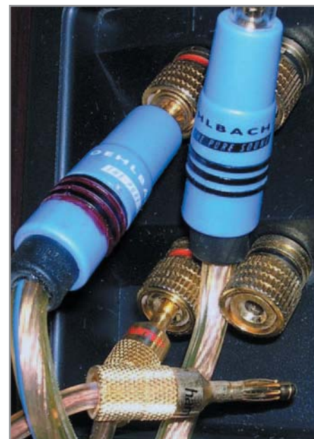
«Бананы» защитят кабели при частом монтаже и демонтаже аппаратуры
