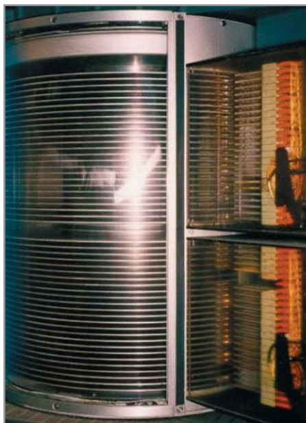
Первый серийный винчестер IBM RAMAC весил около тонны
