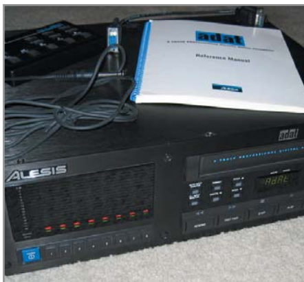
ADAT-магнитофоны работают с кассетами формата S-VHS
